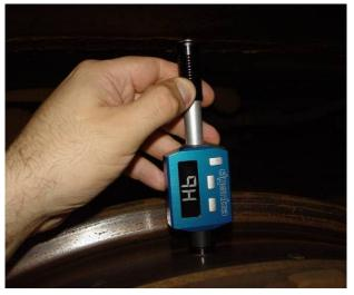
FIGURE 15: SURFACE HARDNESS INSTRUMENT ON A WHEEL
