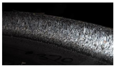
FIGURE 60: CLOSE UP OF THE WORN FLANGE SURFACE OF A VLOCITY WHEEL
