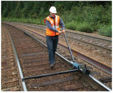
FIGURE 18: SALIENT SYSTEMS PUSH TRIBOMETER [18]
