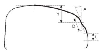
FIGURE 37: RAIL GAUGE ANGLE CALCULATION (MAXIMUM)
